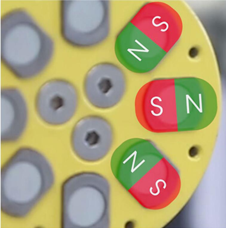
Le défilage de pièces de tôlerie par préhenseur magnétique peut parfois être problématique. En effet, le champ magnétique pénètre en profondeur et peut parfois atteindre plusieurs pièces et donc prendre plusieurs pièces. Ceci s'ajoute à l'effet de succion engendré par la lubrification résiduelle qui tend à ce que les pièces successives se regroupent.
