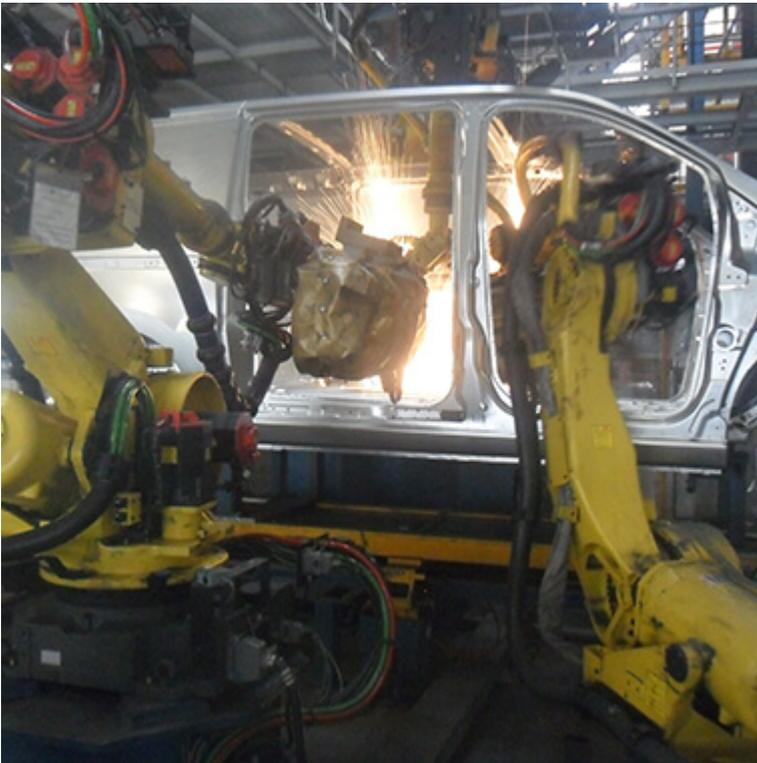
Le savoir-faire PES reconnu sur le marché automobile et hors automobile s'est exprimé dans la création de tous les modules électriques, fluidiques et de puissance nécessaires au transfert entre l'outil et le robot.
