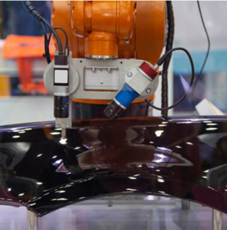
Lorsque l'on utilise un changeur d'outils avec des équipements qui embarquent de telles caméras, le défi principal est de transférer le haut débit de données que demande la transmission vidéo au travers de la connexion rapide du changeur.
