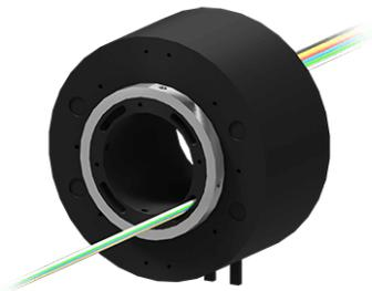
Collecteur tournant pour la transmission de signaux de puissances et/ou de contrôle-commande avec axe creux pour passage d'arbre ou de joint tournant. L'option E1m/E1G offre un canal Ethernet (100BASE-TX ou 1000 BASE-T) sur câble Cat5e et l'option OP1/OP2 permet l'utilisation joint tournant pneumatique intégré tout en transférant 6 à 24 circuits de puissances.
