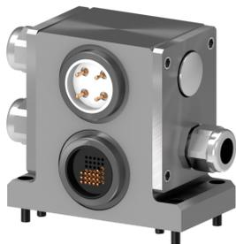
Module électrique Universel coté Outil avec un insert 30 Contacts de 5A , un insert 4 Contacts de 25A avec fiches femelles droites Amphenol 4 et 17 points à bayonnette et une fiche M12 5points femelle au bout de câble de 1.3m.
