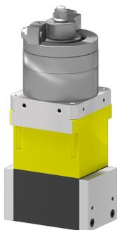
Les modèles 'AR' possèdent un boîtier rectangulaire avec des "pole shoes" interchangeables, ce qui est particulièrement adaptés aux surfaces complexes: tuyaux, cylindres, etc. Cet outil constitue le meilleur choix lorsqu'aucune surface plane n'est disponible sur la pièce à manipuler. Ayant trois surfaces utiles, ces outils procurent une très grande flexibilité pour les applications de préhensions.
