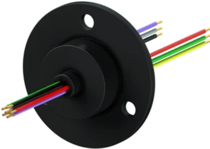
Collecteur tournant convenant particulièrement pour des signaux critiques, tel que pour la haute fréquence, le haut débit, les faibles courants et tensions (jauges de contrainte, thermocouples, équipements de mesure, etc.)
