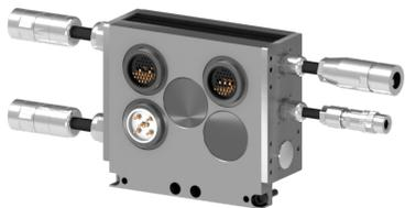
Module côté outil pour application avec une pince BOLLHOFF composé de : Une fiche mâle M8-COD A , une fiche femelle 7/8 5 points (24V), une fiche femelle M23-8 points (Moteur) et une fiche femelle M23-12 points (Codeur) au bout de câbles de 1.3m
