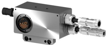
Module côté outil S3/S5 - Version PROFINET 3VS - câbles 1,3m avec une fiche femelle M12-5 CTS Codage L (24VDC) et une fiche M12 4 CTS Codage D mâle (Profinet), embase M12 8 points pour détecteur de sécurité , codage outil sur 3 bits (1-7) inclus.
