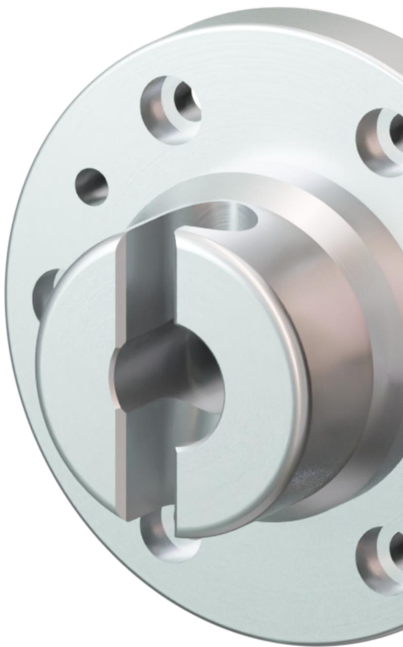
Le changeur SWS est notre modèle le plus robuste destiné aux applications à fortes charges. L'arbre semi-cylindrique relie précisément l'assemblage supérieur et inférieur sans jeu. Un disque de centrage peut être installé sur l'assemblage supérieur (côté robot) et l'assemblage inférieur (côté outil) du robot et garantit que les outils sont correctement alignés avec le bras du robot.
